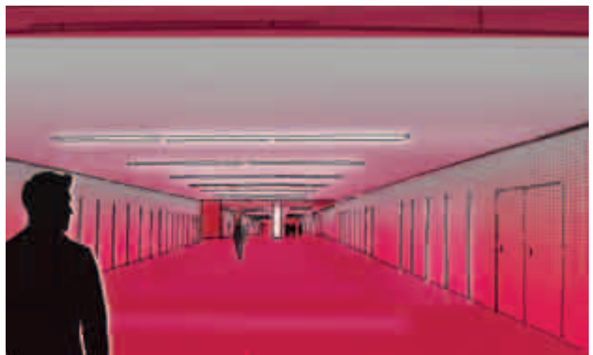
Abb. 80 : Vermeidung Angsträum durch Dimensionierung und Gestaltung der Unterführung
